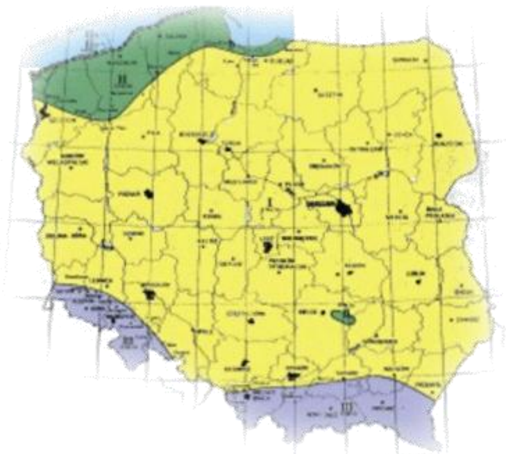
Rozmieszczenie stref wiatrowych. Kolory zielony i fioletowy oznaczają obszary, na których występują wiatry zaburzające ciąg kominowy.
